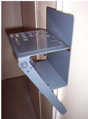
Figure N°3 - Maquette de test faisant varier hauteur et inclinaison
