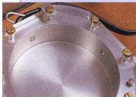
Cette cavité réalisée par Sextant est équipée de transducteurs piézo-électriques.
